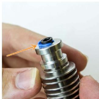
Insérez la collerette noire dans le haut du radiateur, le côté avec les quatre petites jambes doivent rentrer dans la bague en laiton visible en haut du radiateur avec une légère pression des doigts.
