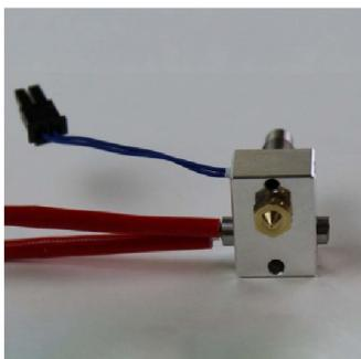
Faites glisser la cartouche de chauffe dans le corps de chauffe. Faites sortir les fils du même côté que vos fils de thermistance.
